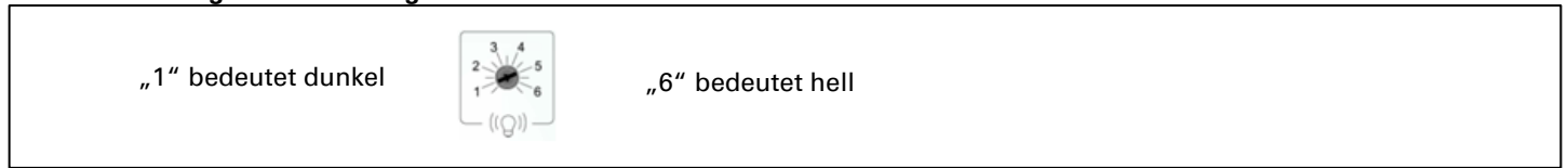
Bild 5: Einstellregler für die Helligkeit des Findelichts
