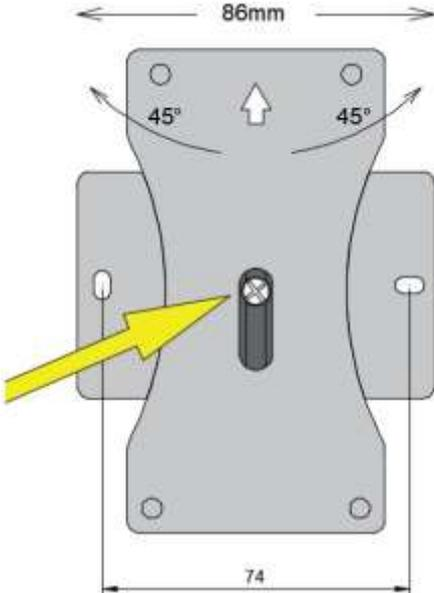
Wandmontage durch 2 im Lieferumfang enthaltenen Schrauben links und rechts.
