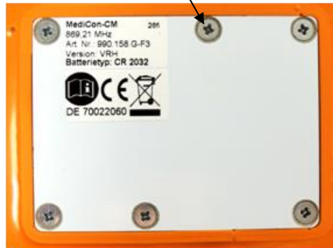
Abb. 1: Batterieabdeckung mit 6 St. Kreuzschlitzschrauben
