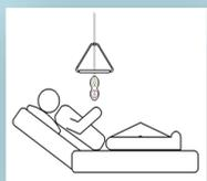
Ein Ruf kann auch liegend durch Zug am Gerät ausgelöst werden, wenn der **VarioPull** beispielsweise am Bettgalgen befestigt ist.
