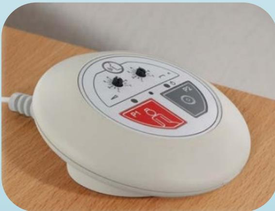
Die Empfindlichkeit des Mikrofons, des Geräuschfilters und das Ansprechzeitverhalten sind individuell und stufenlos einstellbar.
