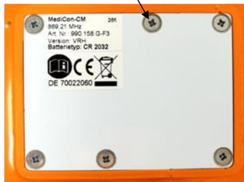
Abb. 1: Batterieabdeckung mit 6 St. Kreuzschlitzschrauben
