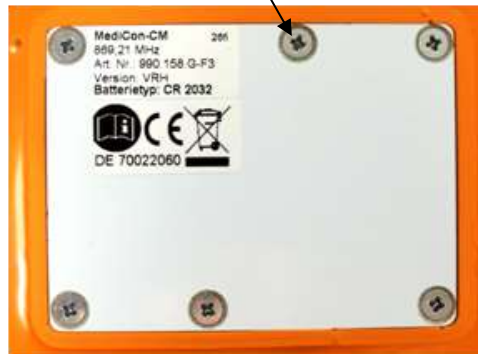
Abb. 1: Batterieabdeckung mit 6 St. Kreuzschlitzschrauben
